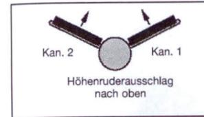
Abbildung 22, Kanalbelegung: Flächenmodelle mit V-Leitwerk
