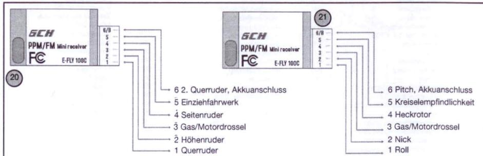
Hinweis: Bei Fliegen eines Modells ohne BEC-Stromversorgung wird ein zusätzlicher Power-Pack benötigt. Dieser kann über ein Schalterkabel an Kanal 6 angeschlossen werden. Ist der Kanal belegt, muss ein V-Kabel verwendet werden.
