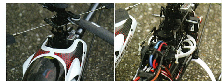
Die Haube ist sauber geschnitten und hakt nicht an Gestänge an (links). Obwohl der BL-Motor relativ klein gebaut ist, hat er es faustdick hinter den Ohren. (rechts)
