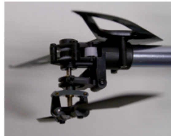
Der starre Heckrotor mit einteiligen Kunststoffblatthaltern, Kunststoffblättern und doppelt geführter Pitch-Schiebehülse
