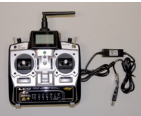
Der hochwertige Sechskanal-Sender mit 2,4-Gigahertz-Technik und Interface für den Anschluss und Betrieb des Flugsimulators am PC
