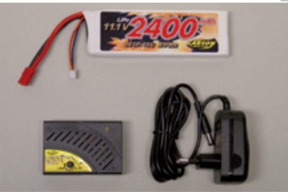
Der 3s/15C-LiPo mit 2.400 Milliampere-stunden Kapazität inklusive Ladegerät und Netzteil. Der Akku wird über den Balanceranschluss geladen und balanciert. Bei 80-prozentiger Entladung benötigt dieser Vorgang gut zweieinhalb Stunden
